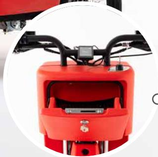
Carrozzeria riciclabile in polietilene gofrato, realizzata mediante stampaggio rotazionale.
