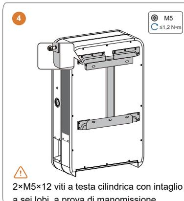
Installare la presa del connettore sul caricatore.
