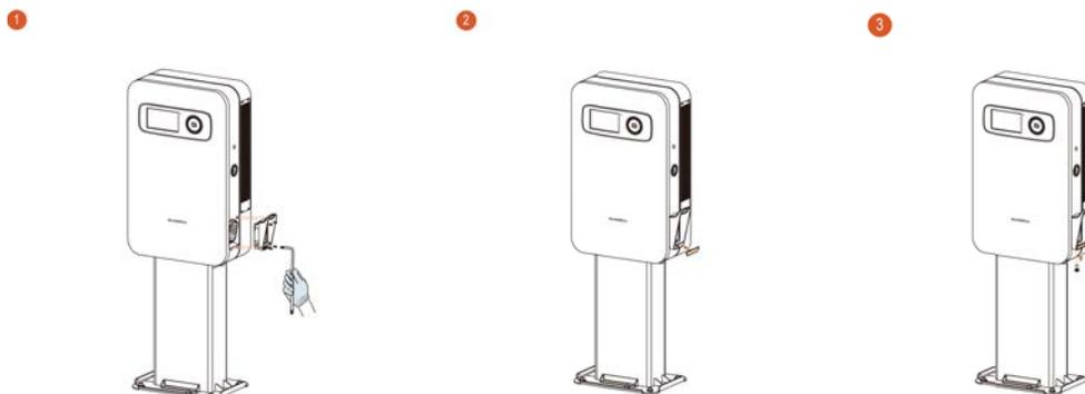
**Figura 2-22** Installazione della presa del connettore
