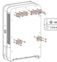
**Figura 2-8** Installazione delle staffe del caricatore
