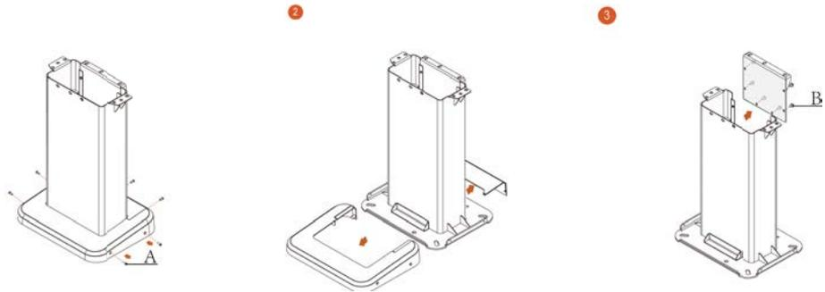
**Figura 2-19** Rimuovere la piastra di copertura posteriore
