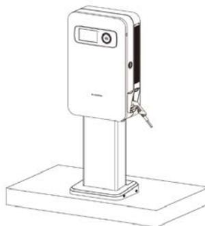
Figura 2-25 Installazione del connettore del caricatore
