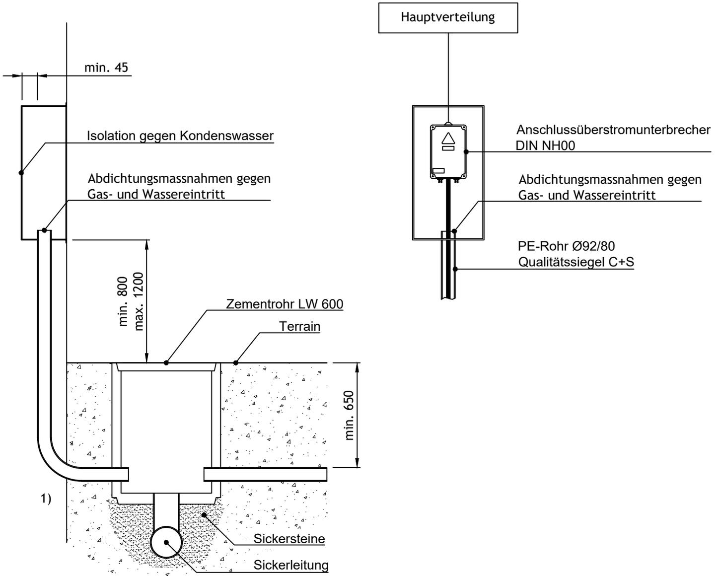
Ausführung bei Gefahr von Wasserführung
