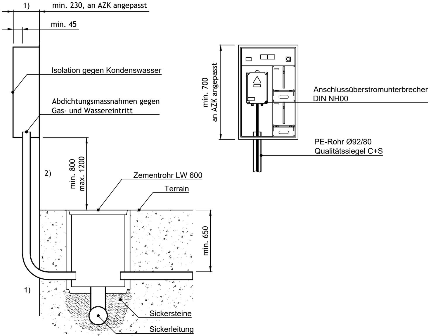
Ausführung bei Gefahr von Wasserführung
