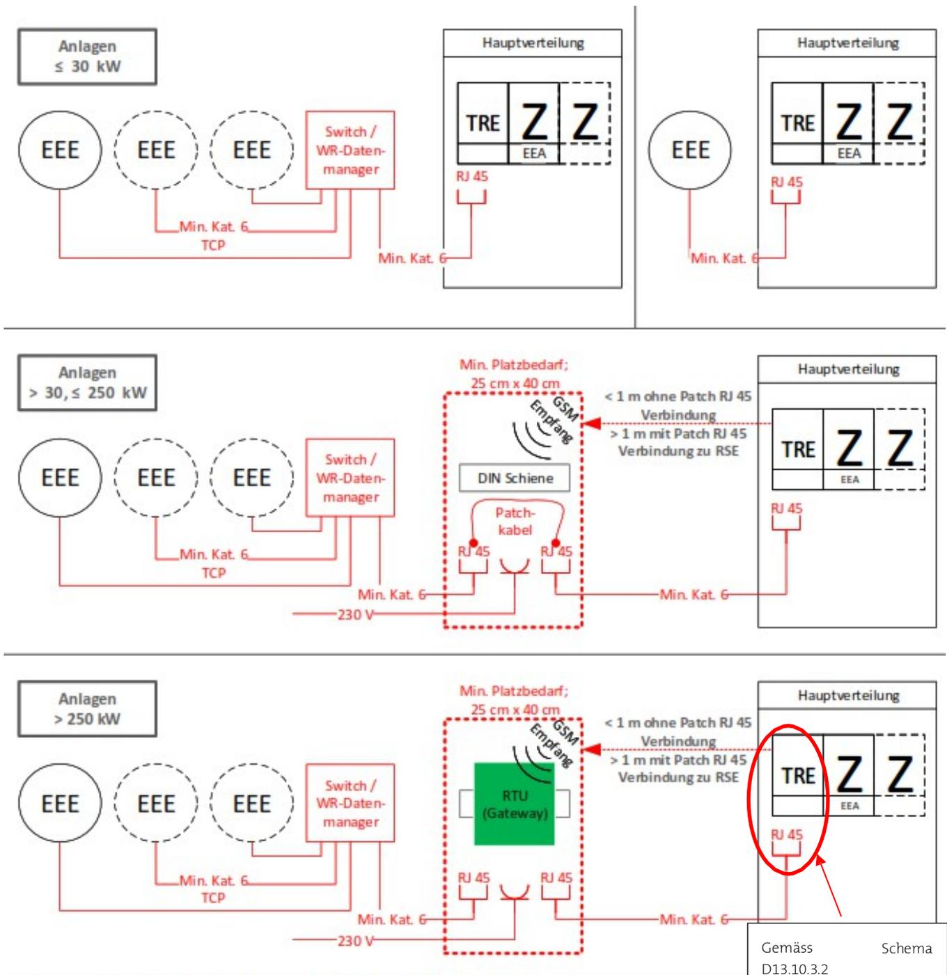
Die Kommunikations-Verbindung wird über den RTU zur Leitstelle Repower erstellt.
