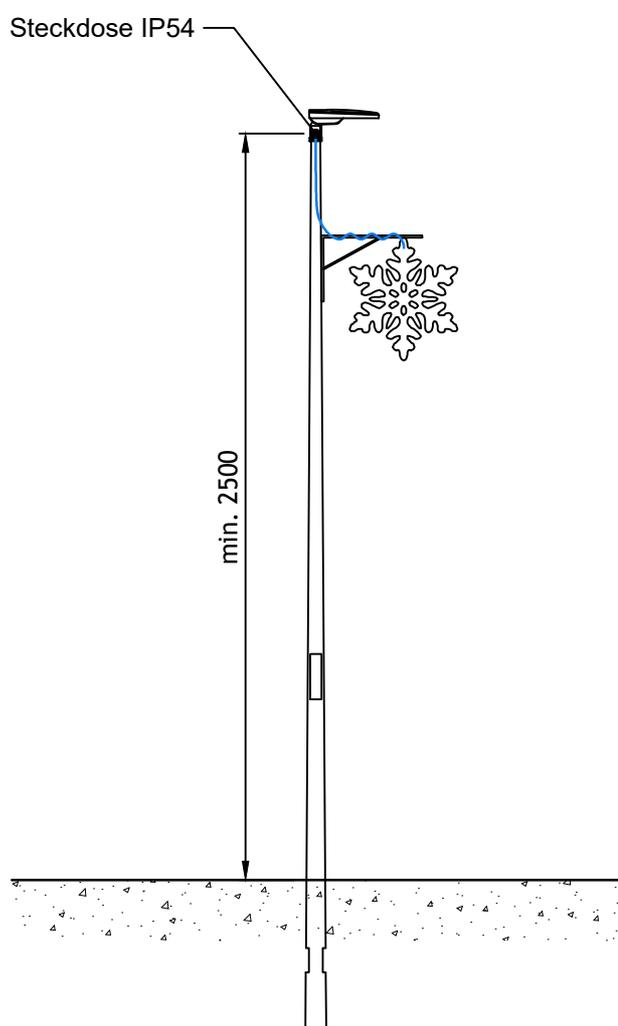
Für Steckdosen im Freien, die sich ausserhalb des Handbereichs befinden, die aber der Stromversorgung von Objekten im Handbereich dienen, muss die Fehlerstromschutzeinrichtung (FI / RCD) 30mA angewendet werden.
